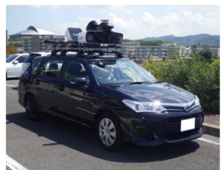
車両に搭載されたMMS
